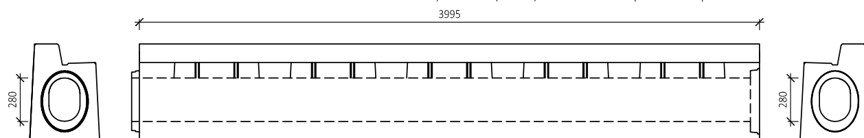
BEST TROUBA S PŘERUŠOVANÝM ŠTĚRBINOVÝM ŽLABEM, ROVNÁ 20/28-28, OBRUBNÍK 12 cm (PROFIL LEVÝ)
