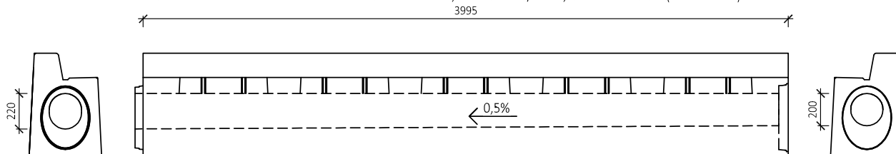
BEST TROUBA S PŘERUŠOVANÝM ŠTĚRBINOVÝM ŽLABEM, SPÁDOVÁ 20/20-22, OBRUBNÍK 15 cm (PROFIL LEVÝ)
