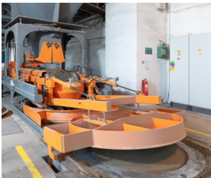
Proces výroby polotovaru systémem vibrolisování
