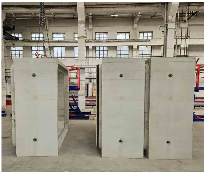
Příprava rámových propustí před stahováním
