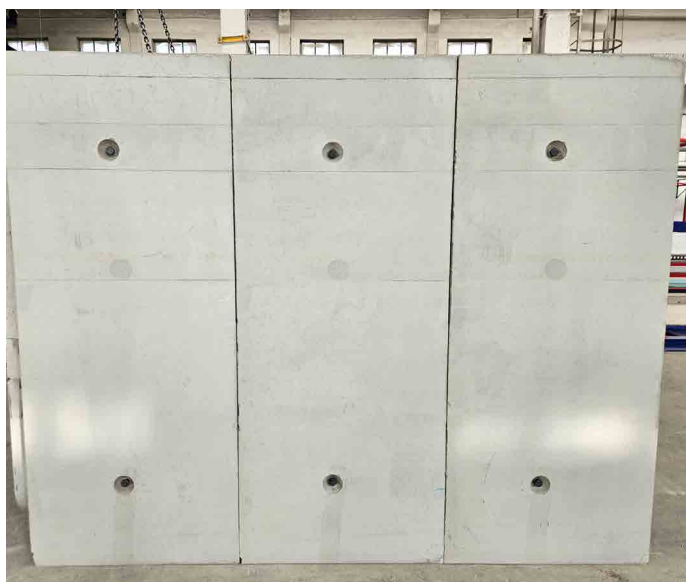
Vnější spára po stažení rámových propustí a demontáži řetězového stahováku
