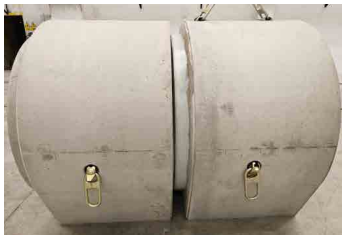
Obr. 4 Detail před stažením – vnější spára
